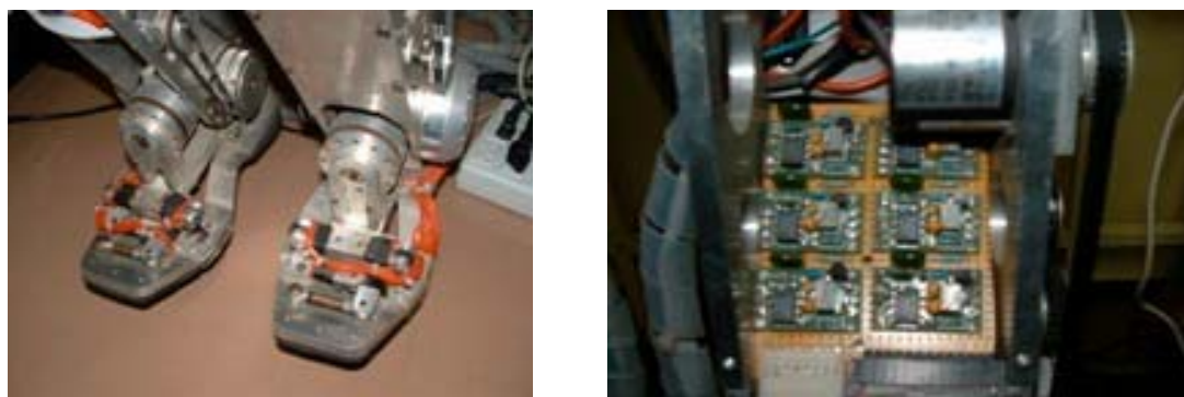
รูปที่ 4.4 แสดงระบบวัดแรงที่เท้า และชุดรับสัญญาณจัดสร้างขึ้น
