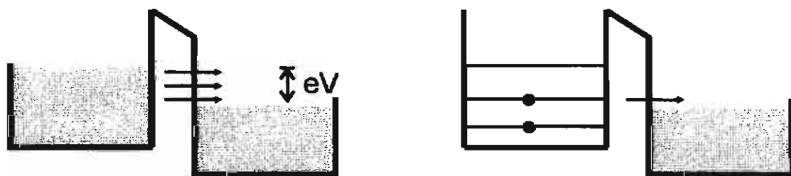
รูปที่ 5 Tunneling ใน Bulk และ Quantum Structure ที่มีความแตกต่างของจำนวนอิเล็กตรอน
