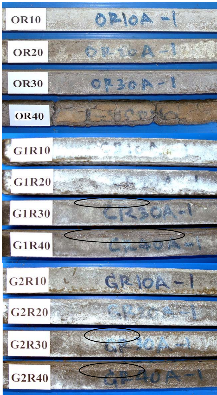
รูปที่ 4.20 ความเสียหายของแท่งมอร์ต้าร์ที่ผสมเถ้ากลบ-เปลือกไม้เมื่อแช่ในสารละลายแมกนีเซียม ซัลเฟตความเข้มข้นร้อยละ 5 ที่อายุ 364 วัน
