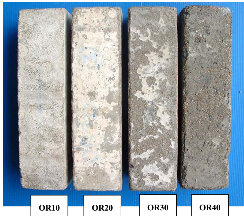
รูปที่ 4.35 ความเสียหายของแท่งคอนกรีตที่ผสมเถ้าแกลบ-เปลือกไม้ OR เมื่อแช่ในสารละลายแมกนีเซียมซัลเฟตความเข้มข้นร้อยละ 5 เป็นเวลา 364 วัน
