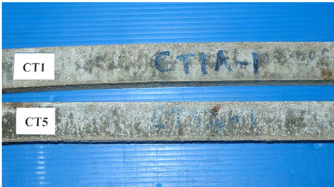
รูปที่ 4.16 ความเสียหายของแท่งมอร์ตาร์ด้ามาตรฐาน CT1 และ CT5 เมื่อแช่ในสารละลายแมกนีเซียมซัลเฟตความเข้มข้นร้อยละ 5 ที่อายุ 364 วัน
