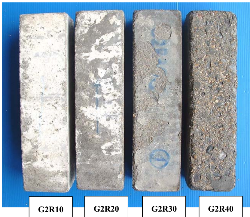
รูปที่ 4.37 ความเสียหายของแท่งคอนกรีตที่ผสมเถ้าแกลบ-เปลือกไม้ G2R เมื่อแช่ในสารละลายแมกนีเซียมซัลเฟตความเข้มข้นร้อยละ 5 เป็นเวลา 364 วัน
