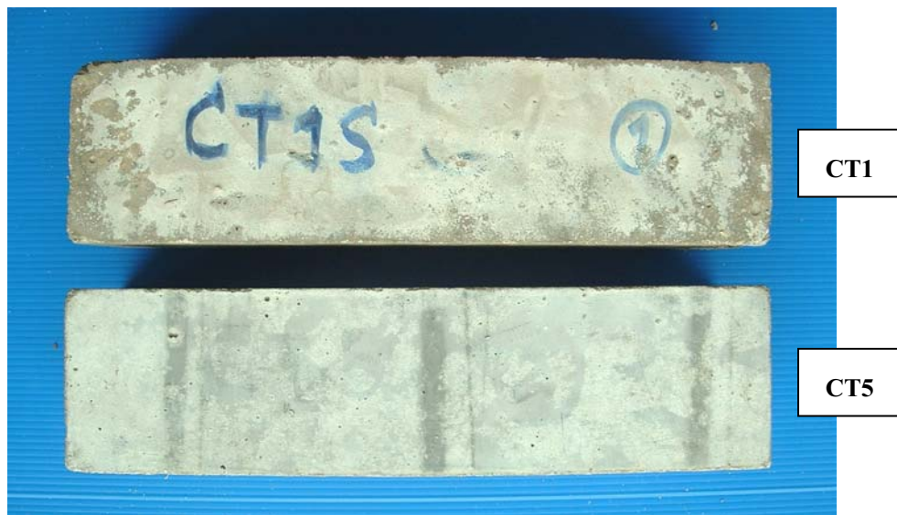
รูปที่ 4.34 ความเสียหายของแท่งคอนกรีตควบคุม CT1 และ CT5 เมื่อแช่ในสารละลายแมกนีเซียมซัลเฟตความเข้มข้นร้อยละ 5 เป็นเวลา 364 วัน
