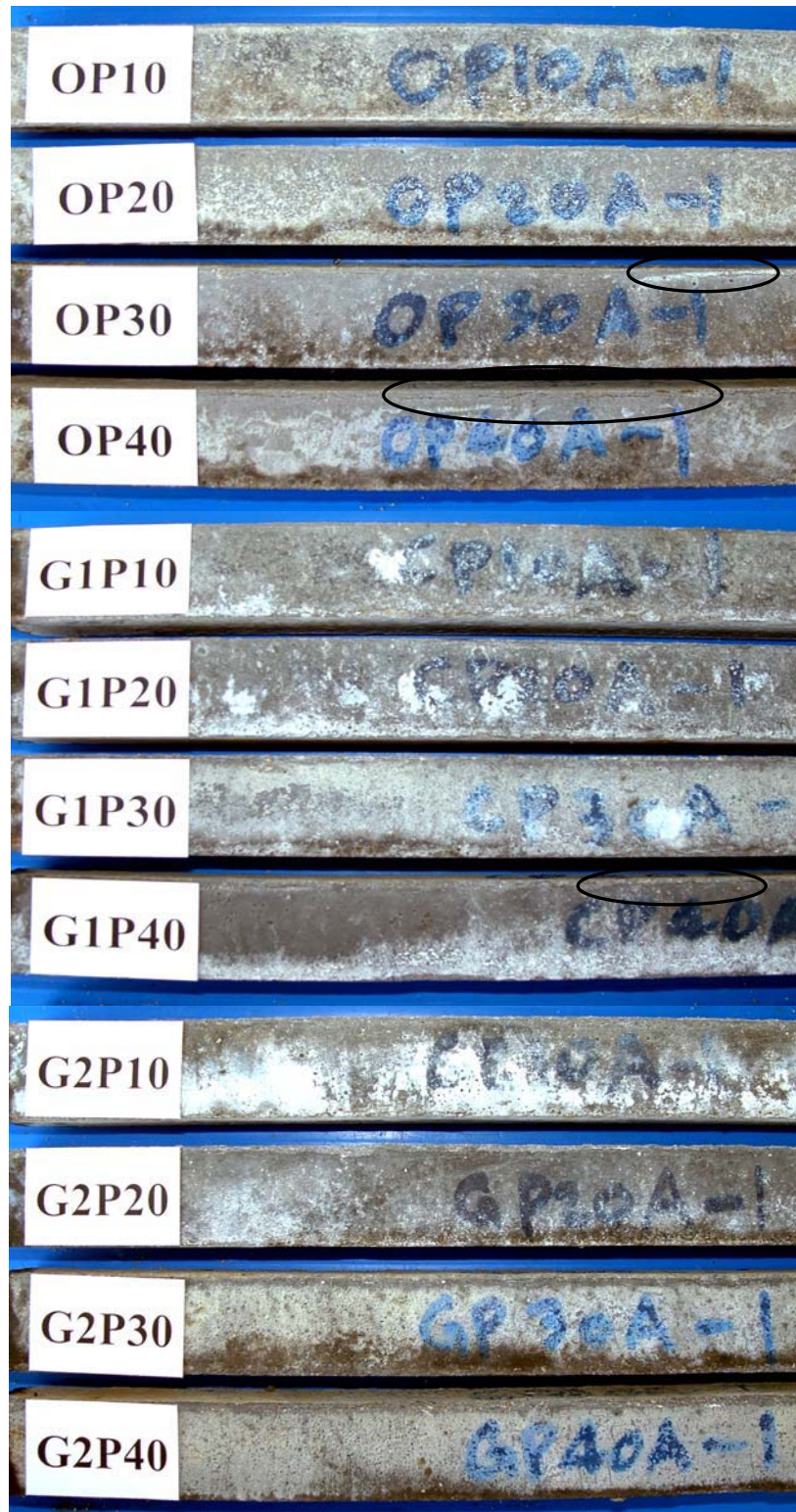
รูปที่ 4.24 ความเสียหายของแท่งมอร์ตาร์ดที่ผสมเถ้าปล้นน้ำมันเมื่อแช่ในสารละลายแมกนีเซียม ซัลเฟตความเข้มข้นร้อยละ 5 ที่อายุ 364 วัน
