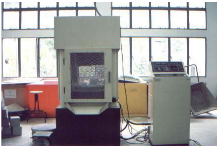
รูปที่ 3.2 เครื่องทดสอบกำลังอัดคอนกรีต
