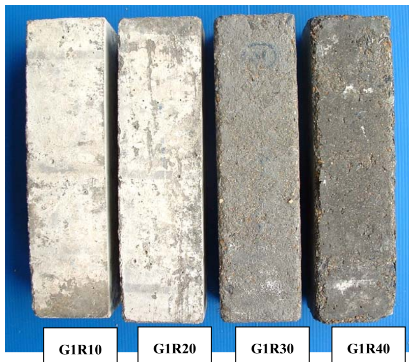
รูปที่ 4.36 ความเสียหายของแท่งคอนกรีตที่ผสมเถ้าแกลบ-เปลือกไม้ G1R เมื่อแช่ในสารละลายแมกนีเซียมซัลเฟตความเข้มข้นร้อยละ 5 เป็นเวลา 364 วัน
