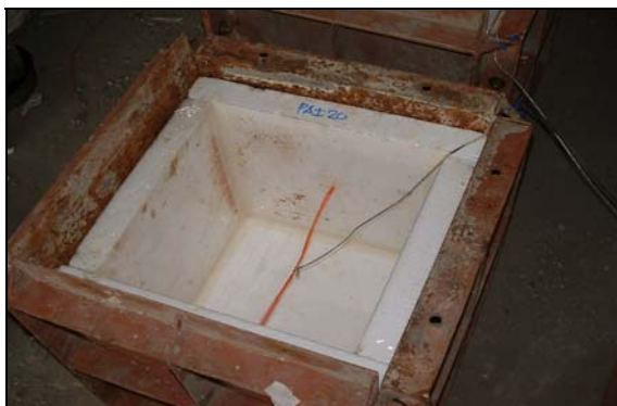
รูปที่ 3.8 แบบหล่อหุ้มฉนวนและการฝังเทอร์โมคัปเปิ้ล
