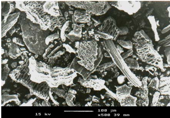
รูปที่ 4.4 ภาพขยายอนุภาคแก้ว-เปลือกไม้ OR
