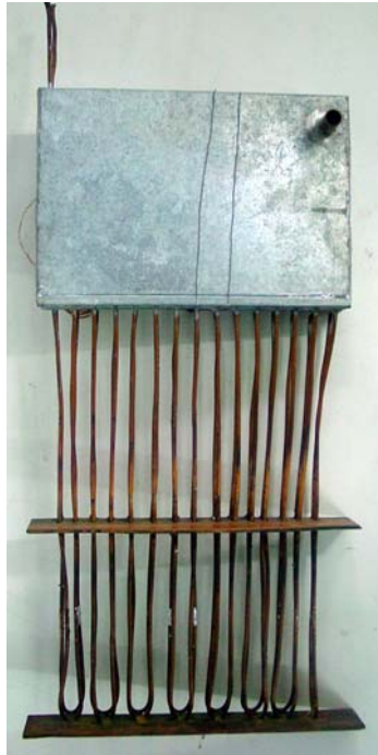
รูป 3.2 ท่อความร้อนแบบสันชนิดปลายปิดที่ติดกล่องความเย็น
