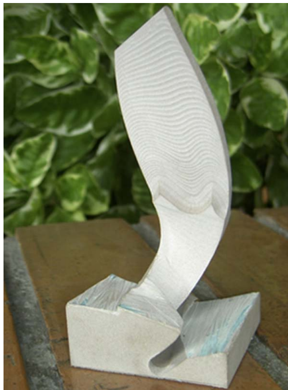
Fig. 16. The blade restoration. Actual machining.
