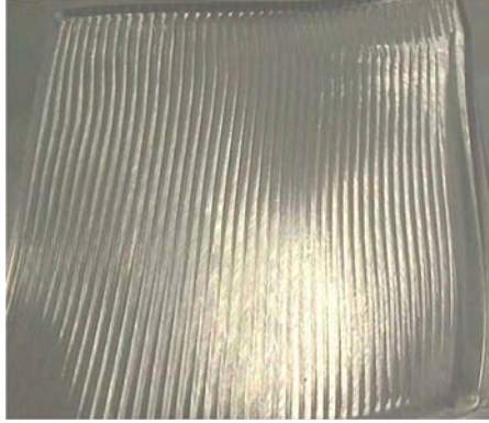
Fig. 5.10. The machined Bezier surface
