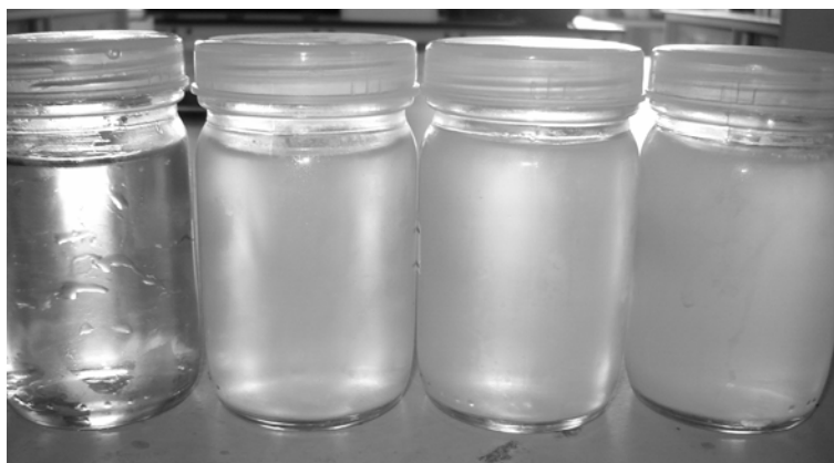
รูปที่ 3.10 ภาพสารแขวนลอยของอนุภาคนาโนของไดบลิค โคพอลิเมอร์ของ MPEG5000 เปรียบเทียบกับน้ำกลั่น จากซ้ายไปขวา: น้ำกลั่น สารแขวนลอยของอนุภาคนาโนของ MPEG5000-PDLL MPEG5000-PDLLG และ MPEG5000-PDLLGCL ตามลำดับ
