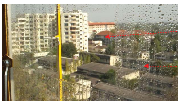
รูปที่ 3.19 แสดงกระจกหน้าต่างที่ทำการเคลือบด้วยหัวสปาร์กชนิดด้ามจับ เปรียบเทียบระหว่างบริเวณที่เคลือบด้วย \text{TiO}_2 (ไม่เป็นหยดน้ำ) และบนผิวกระจกปกติที่ไม่ได้เคลือบด้วย \text{TiO}_2 (มีหยดน้ำเกาะ)
