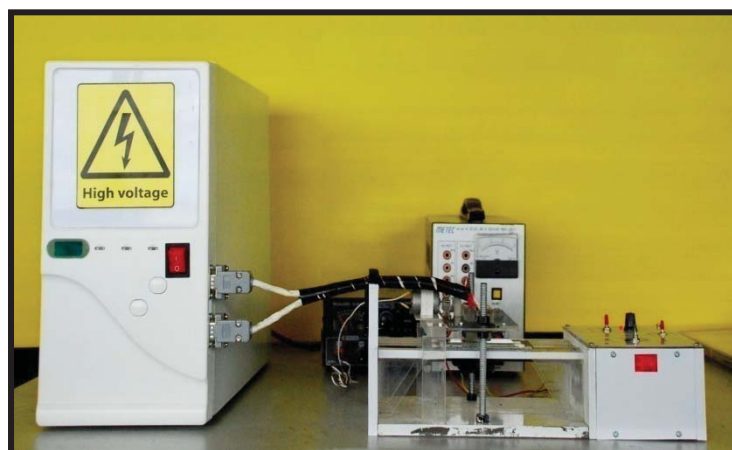
รูปที่ 3.4 เครื่องสังเคราะห์ฟิล์มบางของโลหะออกไซด์ด้วยกระบวนการสปาร์กVersion 2 พร้อมรางเลื่อนอัตโนมัติ
