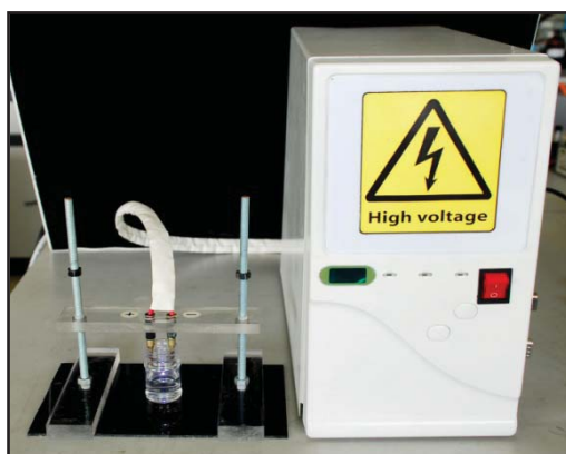
รูปที่ 3.2 เครื่องสังเคราะห์หอนาโนของโลหะออกไซด์ด้วยกระบวนการสปาร์ก Version 1
