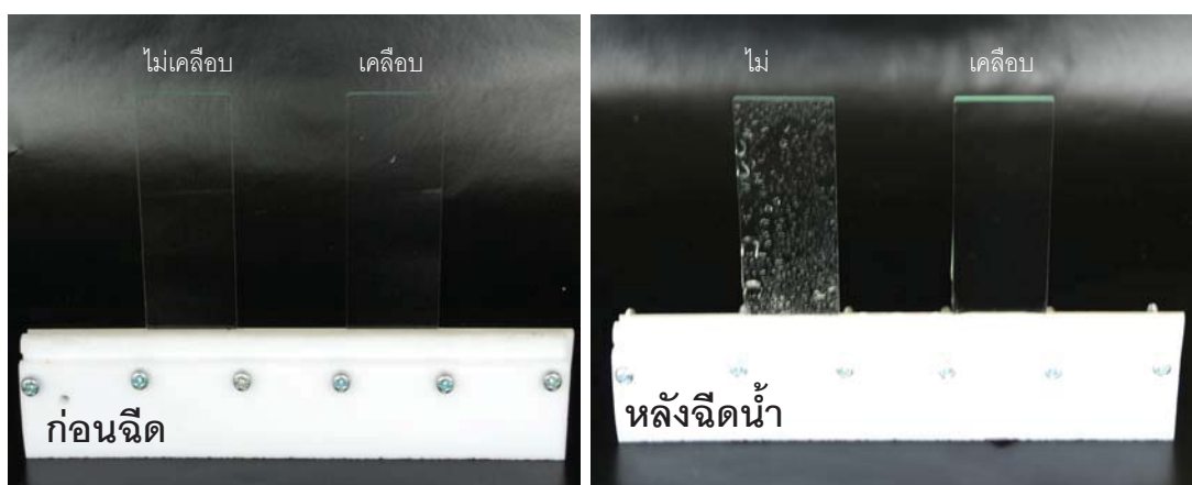
รูปที่ 3.21 เปรียบเทียบลักษณะของกระจกที่เคลือบฟิล์มบางและไม่เคลือบฟิล์มบางก่อนและหลังฉีดพ่นละอองน้ำ
