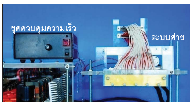
รูปที่ 3.8 หัวสปาร์กพร้อมระบบสายและ ชุดควบคุมความเร็วระบบสาย
