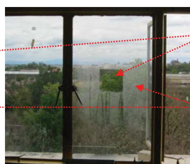
รูปที่ 3.19 แสดงกระจกหน้าต่างที่ทำการเคลือบด้วยหัวสปาร์กชนิดด้ามจับ เปรียบเทียบระหว่างบริเวณที่เคลือบด้วย \text{TiO}_2 (ไม่เป็นหยดน้ำ) และบนผิวกระจกปกติที่ไม่ได้เคลือบด้วย \text{TiO}_2 (มีหยดน้ำเกาะ)
