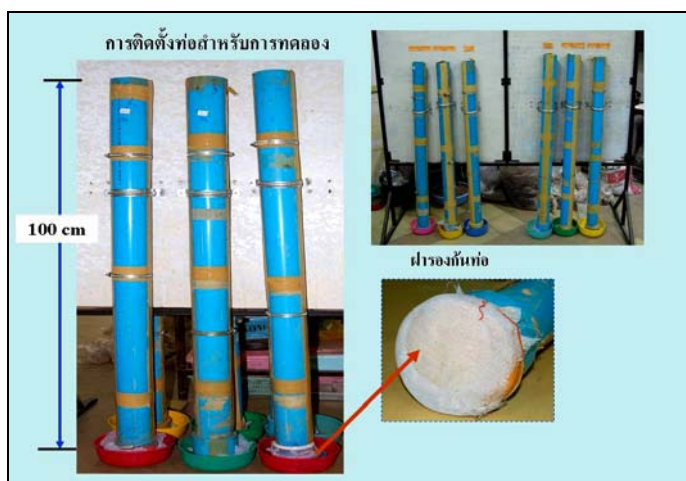
ภาพที่ 3.4 การติดตั้งหน่วยทดลอง
