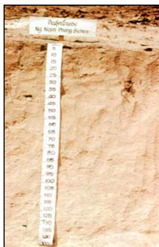
ภาพที่ 3.3 หน้าตัดดิน (soil profile) ชุดดินน้ำพอง (Ng series)
