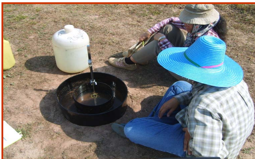
ภาพภาคผนวกที่ 4 การศึกษาคุณสมบัติทางกายภาพ ( การวัดอัตราการแทรกซึมน้ำในดินโดยวิธี Double ring) ในแปลงทดลองการศึกษาสารอินทรีย์ต่างคุณภาพในระยะยาวที่ท่าพระ
