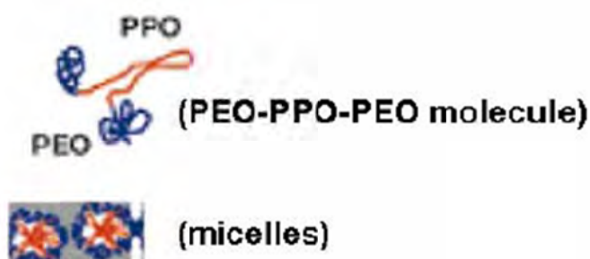
รูปที่ 2.13 การเกิดไมเซลล์ของไตรบล็อกโคพอลิเมอร์ชนิด (PEO-PPO-PEO) (Soler-Illia และคณะ, 2000)
