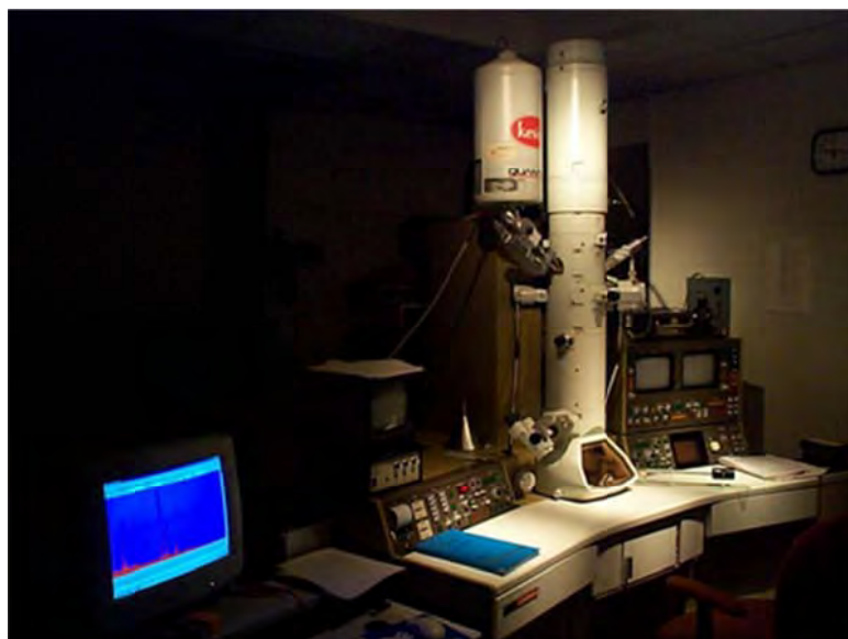
รูปที่ 3.6 กล้องจุลทรรศน์อิเล็กตรอนแบบส่องทะลุผ่าน รุ่น JEOL JEM 2100F (Japan)
