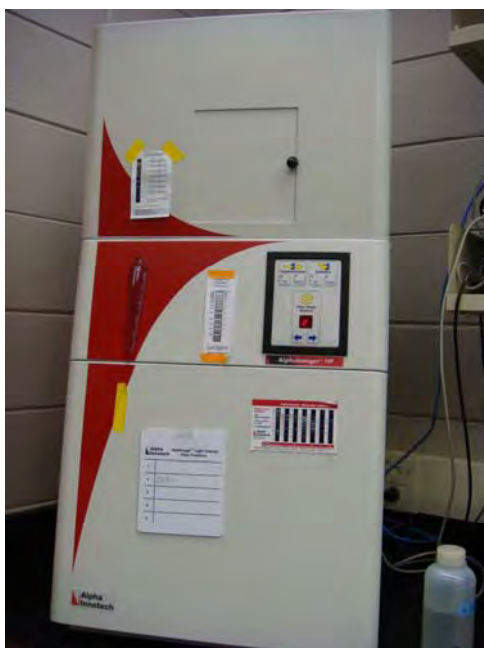
รูปที่ 22 เครื่องอ่านแถบ DNA Alphamager® HP Imaging System (ซ้าย) และ คอมพิวเตอร์ที่เชื่อมต่อเพื่อดูแถบ DNA ที่ปรากฏบนจอภาพภายหลังการฉายแสง UV ในเครื่องอ่านเจล
