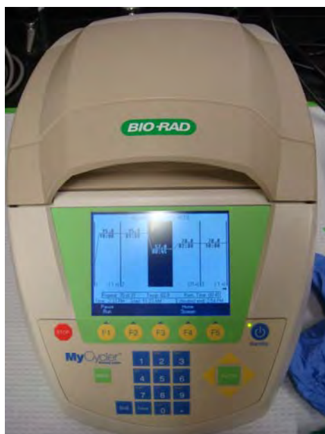
รูปที่ 25 เครื่องควบคุมปฏิกิริยาอัตรโนมัติ (Polymerase Chain Reaction machine) ที่ใช้ในการทดลองครั้งนี้
