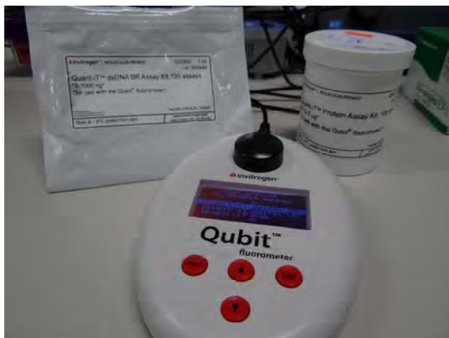
รูปที่ 5 เครื่องมือ Qubit™ fluorometer และชุดตรวจสอบโปรตีน และ dsDNA
