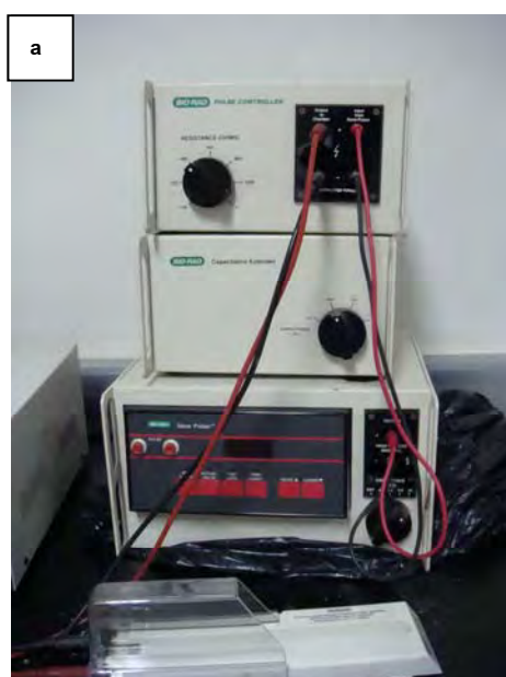
รูปที่ 16 เครื่อง Electroporator ที่ใช้สำหรับการทำ mutagenesis (a) แท่งพลาสติกที่มี cuvette ซึ่งมีส่วนผสมของ เซลล์แขวนลอยแบคทีเรียสายพันธุ์ RS 83 และผลิตภัณฑ์ EZ-Tn5™ <KAN> Tnp Transposome™ เสียบตรงช่อง ด้านซ้าย (b) และการเสียบแท่งพลาสติกเข้าไปในแท่นชาร์จก่อนกดปล่อยกระแสไฟ(c)
