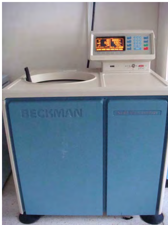
รูปที่ 3 เครื่องปั่นเหวี่ยงความเร็วสูงสำหรับใช้ตกตะกอน crude LPS ที่สกัดออกมาจากเชื้อสายพันธุ์ RS83
