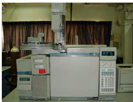
รูปที่ 62 การบ่มสาร GA3 บริสุทธิ์ที่ทำปฏิกิริยากับ pyridine และ BSTFA ที่มีส่วนผสมของ 1% TMCS ใน water bath ที่อุณหภูมิ 60 องศาเซลเซียส นาน 30 นาที (รูปซ้าย) ก่อนนำไปวิเคราะห์สารในเครื่อง GC-MS (รูปขวา)
