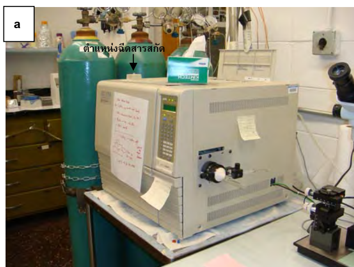
รูปที่ 81 เครื่อง Gas Chromatography (GC) ที่ใช้สำหรับวิเคราะห์สารอินทรีย์ระเหยที่ปลดปล่อยออกมาจากเชื้อแบคทีเรีย (a) และการฉีดสารสกัดเข้าสู่เครื่อง GC บริเวณตำแหน่งฉีดสารที่อยู่ด้านบนของเครื่อง (b)
