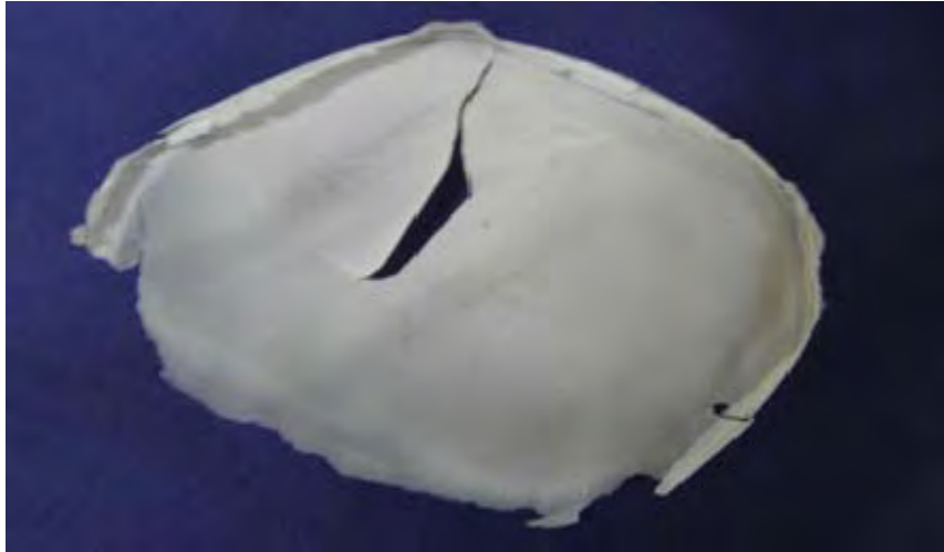
ภาพที่ 4.13 โปโอพอลิเมอร์ PHB ที่สกัดได้จากเซลล์ของจุลินทรีย์ Bacillus aryabhattai โดยใช้กากคั้นจากลำต้นข้าวฟ่างหวานเป็นแหล่งอาหาร
