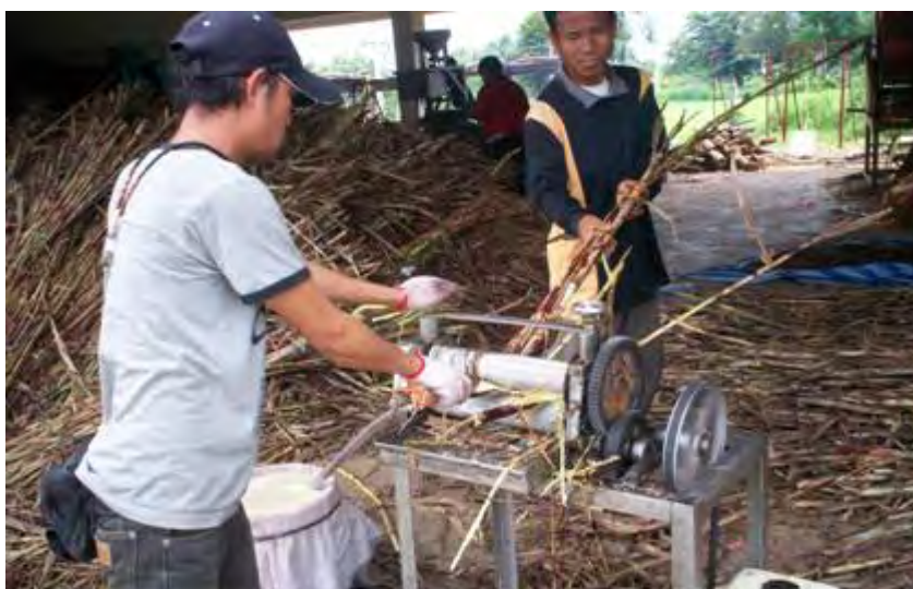
ภาพที่ 4.1 แสดงการคั้นน้ำข้าวฟ่างหวานจากลำต้นข้าวฟ่างหวานโดยใช้เครื่องบีบอัด
