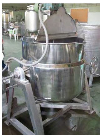
ภาพที่ 3.2 การต้มน้ำลำไยให้เข้มข้นโดยใช้หม้อต้มสองชั้น (double steam jacket)
