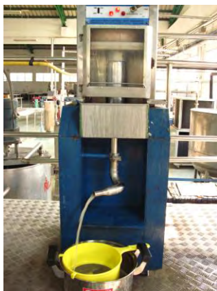
ภาพที่ 3.1 การคั้นน้ำลำไยโดยใช้เครื่องบีบอัดด้วยระบบไฮดรอลิก (hydraulic press)
