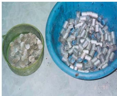
ภาพที่ 10 ท่อและฝาปิดอลูมิเนียมใช้ทำเปลือกบรรจุ และการเปรียบเทียบกับท่อพีวีซี
