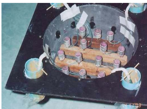
ภาพที่ 12 อุปกรณ์จุดลูกไฟจากได้น้ำแบบจุดเป็นชุดบรรจุทีละหลายลูก
