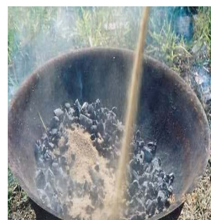
ภาพที่ 2 การเตรียมถ่านไม้แบบเผาในถัง แบบเผาในกะทะ และการใช้ทรายกลบเพื่อดับถ่าน
