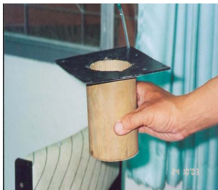
ภาพที่ 11 อุปกรณ์จุดจากใต้น้ำทำจากแผ่นฟิวเจอร์บอร์ดและกระบอกไม้ไผ่
