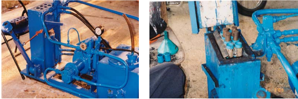
ภาพที่ 5 เครื่องไฮดรอลิกอัดดินขับและช่องบรรจุเปลือกพีวีซี พร้อมแกนเหล็กสำหรับอัด
