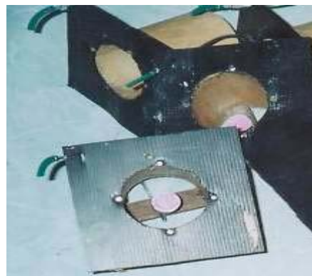
ภาพที่ 11 อุปกรณ์จุดจากใต้น้ำทำจากแผ่นฟิวเจอร์บอร์ดและกระบอกไม้ไผ่
