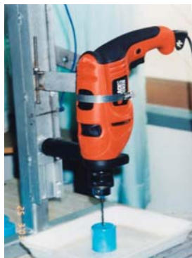
ภาพที่ 6 สว่านเจาะรูปักแกนหมุนและทางไฟออก พร้อมทั้งตั้งมุมและความลึกของการเจาะ
