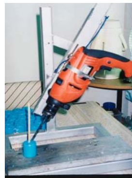
ภาพที่ 6 สว่านเจาะรูปักแกนหมุนและทางไฟออก พร้อมทั้งตั้งมุมและความลึกของการเจาะ
