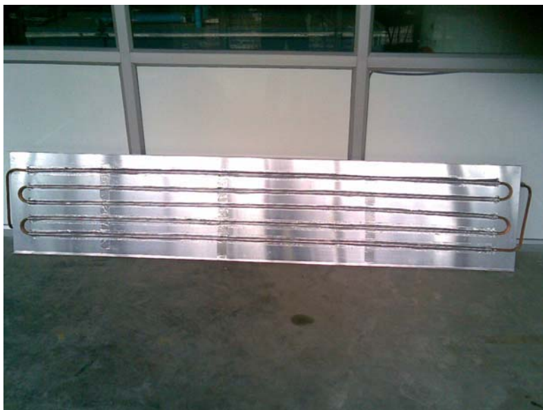
รูปที่ 3.8 การประกอบท่อทองแดงให้ยึดติดกับแผ่นอะลูมิเนียม
