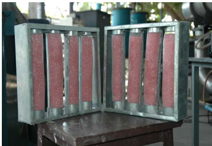
รูปที่ 3.21 ลักษณะสีของสารดูดความชื้น ซิลิกาเจลเปลี่ยนจากสีน้ำเงินเข้มเป็นสี ชมพูอ่อน เมื่อผ่านการใช้งานในระบบดูดกลืนความชื้นจากอากาศในห้องทดลอง
