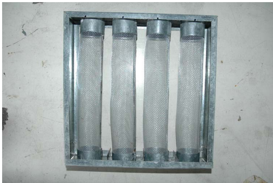
รูปที่ 3.32 แผงบรรจุสารดูดความชื้น สามารถบรรจุ ซิลิกาเจลได้ 1.1 kg / แผง
