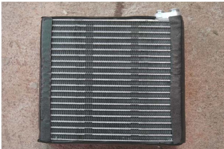
รูปที่ 3.14 ลักษณะของอุปกรณ์แลกเปลี่ยนความร้อน Cooling Coil ที่ใช้ในการทดลอง
