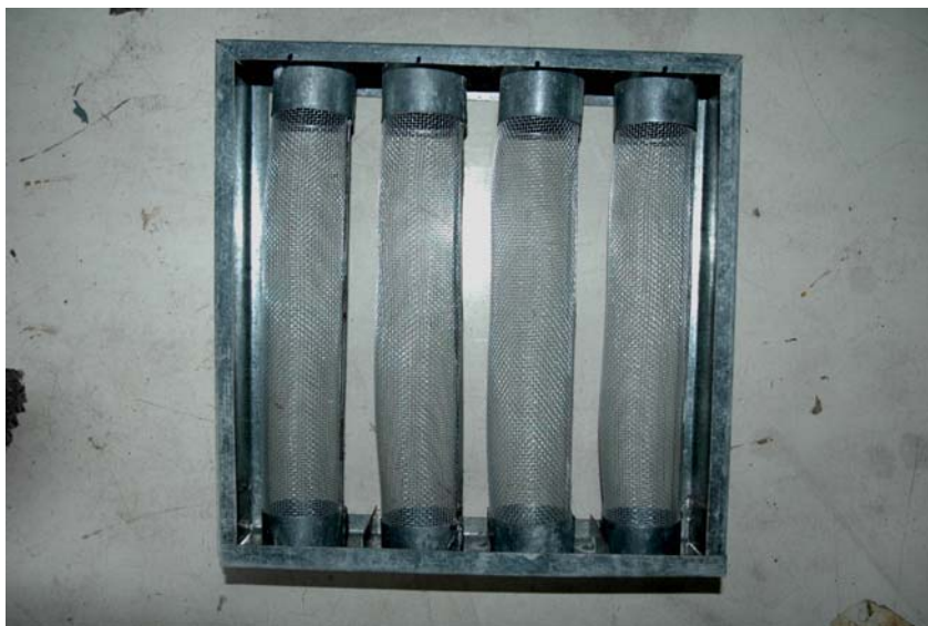
รูปที่ 3.19 แสดงลักษณะโครงสร้างของแผงบรรจุสารดูดความชื้น ซิลิกาเจล
