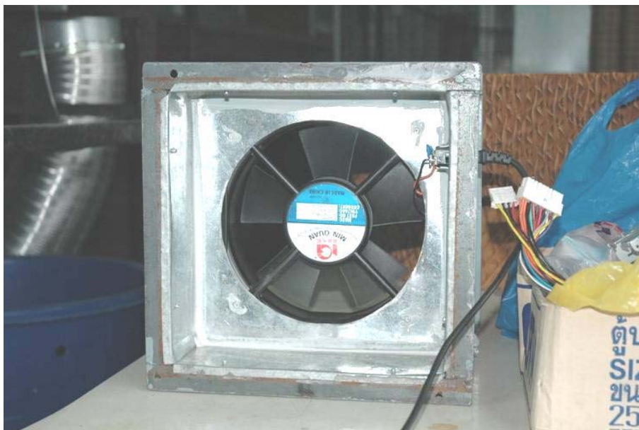
รูปที่ 3.33 พัดลมดูดอากาศ MITSHUBISHI 8 นิ้ว 540 m 3 /hr
