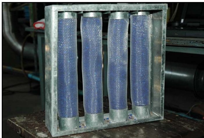
รูปที่ 3.20 ลักษณะของแผงบรรจุสารดูดความชื้น ที่บรรจุสาร ซิลิกาเจลเรียบร้อยแล้ว
