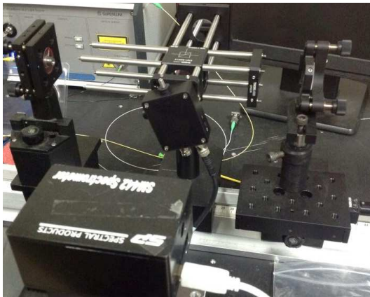
Figure 2: เทคนิคการหาช่วงการเกิด coherence โดยใช้ spectrometer SM442
