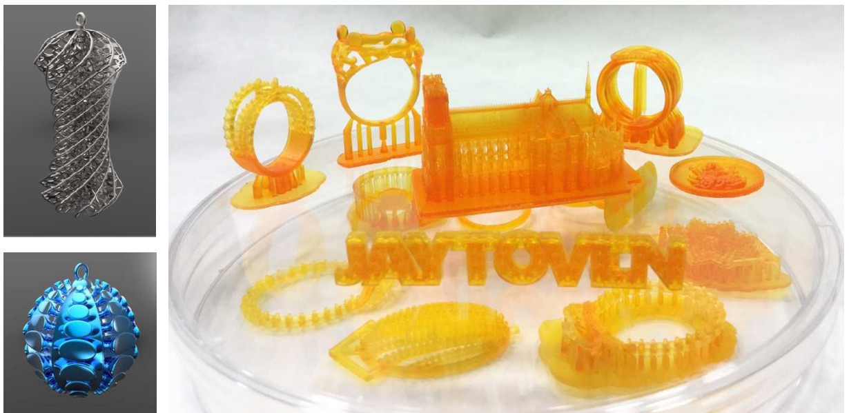
รูปที่ 1 แสดงตัวอย่างไฟล์สามมิติของอัญมณีที่ออกแบบขึ้น และภาพตัวอย่างต้นแบบที่สร้างด้วยเครื่องพิมพ์สามมิติ ซึ่งต่อไปจะพัฒนาให้สามารถยึดติดกับทับทิม เพื่อเพิ่มมูลค่าและศักยภาพการแข่งขันต่อไป
