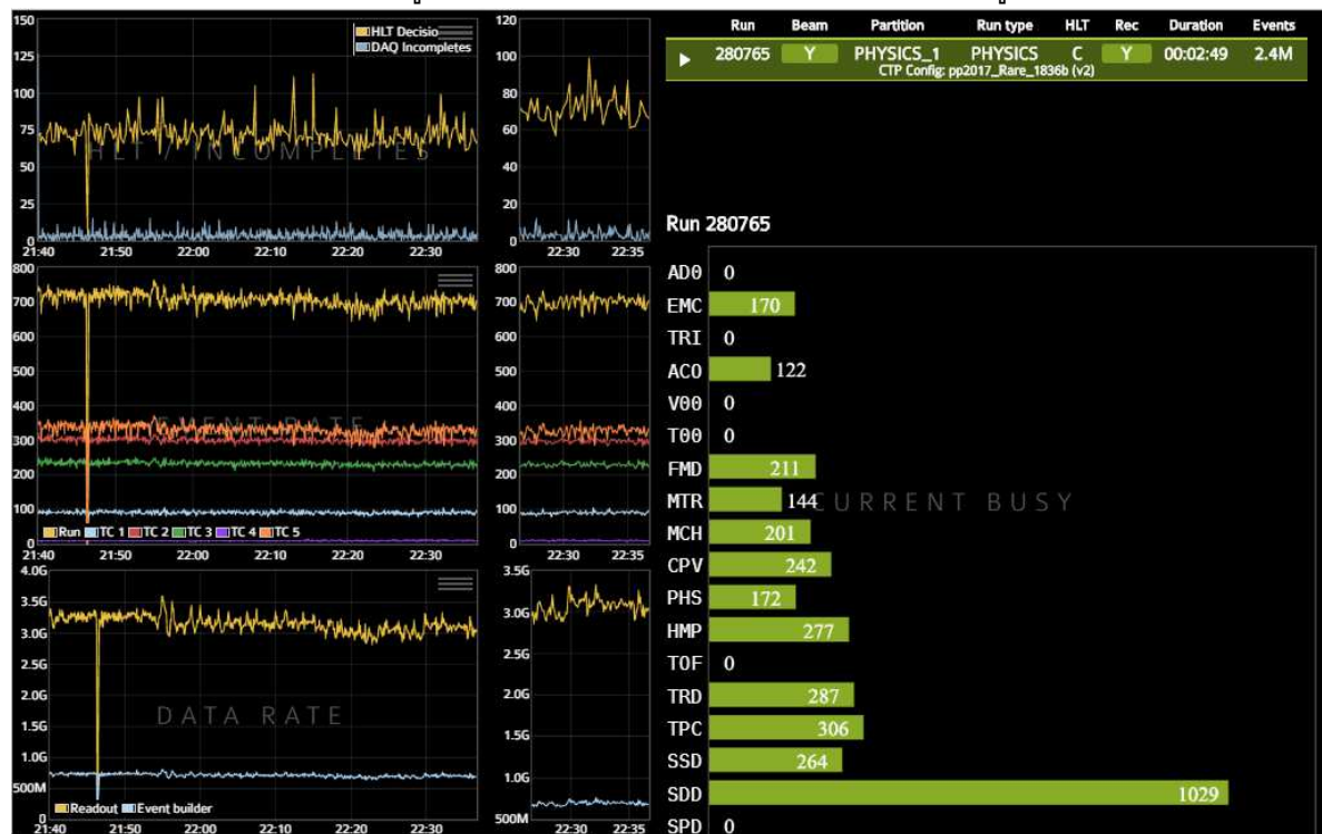
รูปที่ 3 หน้าจอ Experiment Control system (a.) การเก็บอัตราการความไม่สมบูรณ์ของเหตุการณ์ในการเก็บข้อมูล และอัตราการเก็บข้อมูล(ในคอลัมป์ด้านซ้ายมือ) และ (b) busy time ของ หัววัดแต่ละชนิด(คอลัมป์ด้านขวามือ)ในหัววัด ALICE
