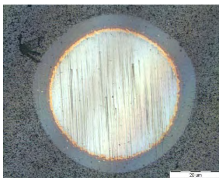
รูปที่ 3.23 ภาพถ่ายจากกล้องจุลทรรศน์แสดงความหนาของฟิ์มส์จากการทดสอบด้วยเครื่อง Calotest
