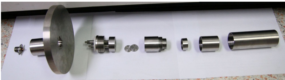
รูปที่ 13 องค์ประกอบของหัวแมกนีตรอนขนาดหนึ่งนิ้วที่สร้างขึ้น
