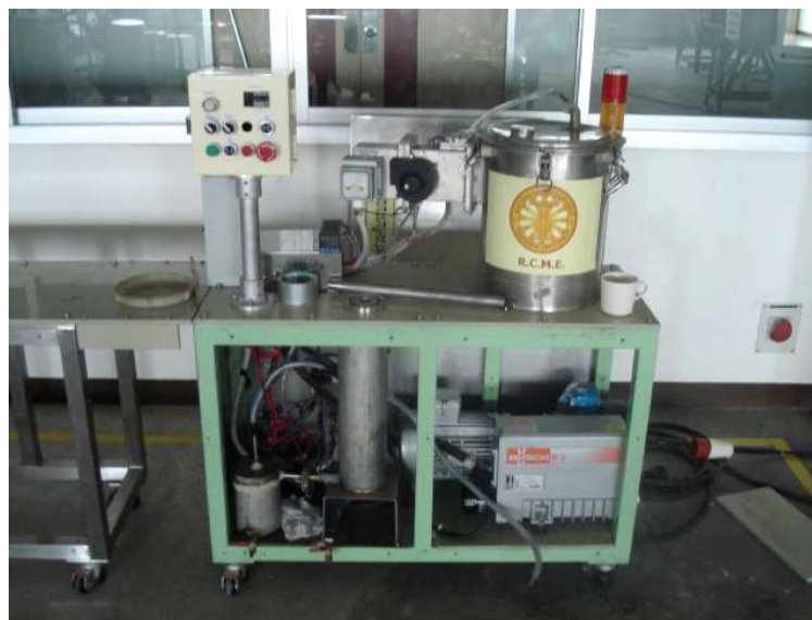
ภาพที่ 4.1 ระบบอบแห้งอเนกประสงค์เชิงพาณิชย์โดยใช้ไมโครเวฟร่วมกับระบบสุญญากาศ (Laboratory Scale)
