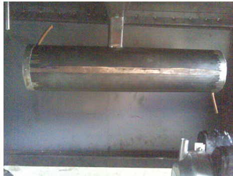
ภาพที่ 4.19 ถังควบแน่น (Condensing Tank)
