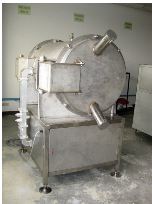
ภาพที่ 4.3 ระบบอบแห้งอเนกประสงค์เชิงพาณิชย์โดยใช้ไมโครเวฟร่วมระบบสุญญากาศ (Single-Feed High Power Magnetron)
