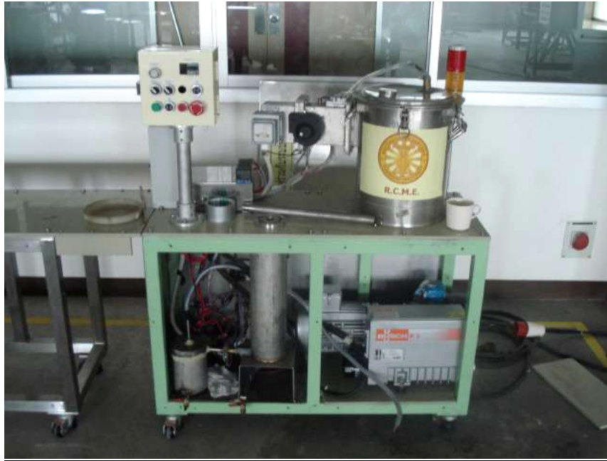
ภาพที่ 6.1 ระบบอบแห้งอเนกประสงค์เชิงพาณิชย์โดยใช้ไมโครเวฟร่วมระบบสุญญากาศ (Laboratory Scale)
