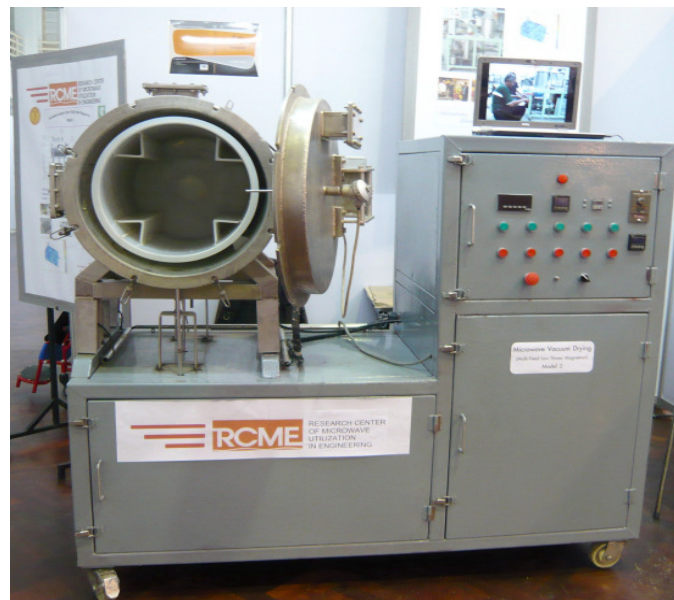
ภาพที่ 6.2 ระบบอบแห้งอเนกประสงค์เชิงพาณิชย์โดยใช้ไมโครเวฟร่วมกับระบบสุญญากาศ (Multi-Feed Low Power Magnetron)
