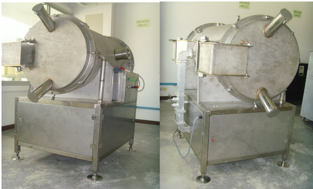
ภาพที่ 4.15 เครื่องอบแห้งอเนกประสงค์เชิงพาณิชย์โดยใช้ไมโครเวฟร่วมกับระบบสุญญากาศ แบบ Single-Feed High Power Magnetron ที่สร้างขึ้น
