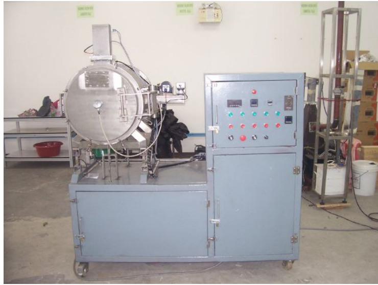
ภาพที่ 4.14 เครื่องอบแห้งอเนกประสงค์เชิงพาณิชย์โดยใช้ไมโครเวฟร่วมกับระบบสุญญากาศ แบบ Multi-Feed Low Power Magnetron ที่สร้างขึ้น
