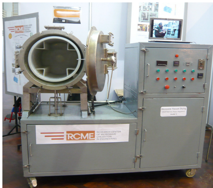
ภาพที่ 4.2 ระบบอบแห้งอเนกประสงค์เชิงพาณิชย์โดยใช้ไมโครเวฟร่วมกับระบบสุญญากาศ (Multi-Feed Low Power Magnetron)
