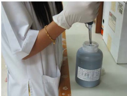
รูปที่ 1.8 ขั้นตอนการตรวจวิเคราะห์น้ำเสียในการตรวจวินิจฉัยจุลชีพ (Protozoa & Rotifers)
