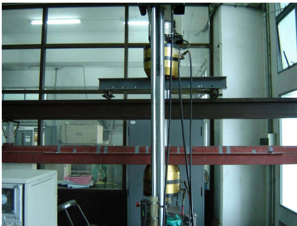
รูปที่ 2 การติดตั้งการทดสอบแรงดัดแบบ 4 จุดของวัสดุหน้าตัดประกอบ
