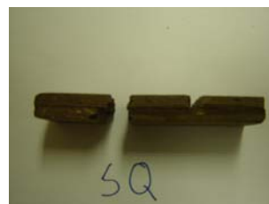
รูปที่ 5 การพังของชิ้นงานที่ยึดด้วยกาวยี่ห้อ SQ
