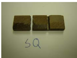
รูปที่ 5 การพังของชิ้นงานที่ยึดด้วยกาวยี่ห้อ SQ
