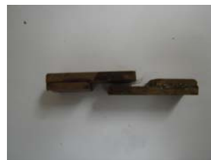
รูปที่ 6 การพังของชิ้นงานที่ยึดด้วยกาวยี่ห้อ EP
