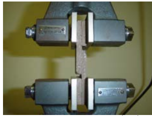
รูปที่ 4 ลักษณะการติดตั้งชิ้นงาน
