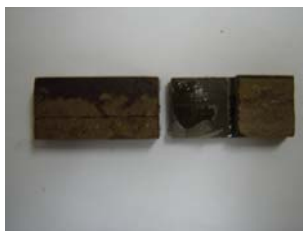
รูปที่ 6 การพังของชิ้นงานที่ยึดด้วยกาวยี่ห้อ EP
