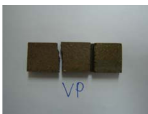
รูปที่ 7 การพังของชิ้นงานที่ยึดด้วยกาวยี่ห้อ LI
