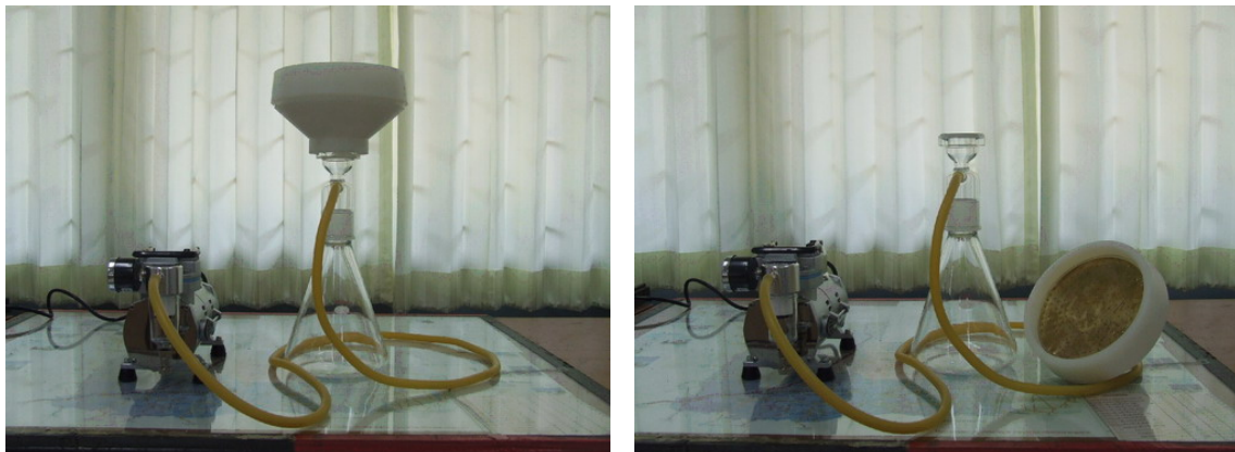
รูปที่ 3.5 เครื่องมือทดสอบการอุ้มน้ำของมอร์ตาร์ตามมาตรฐาน ASTM C1506-03
