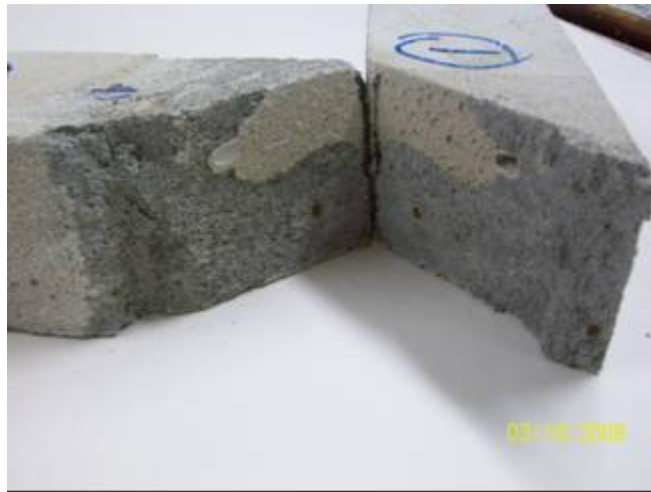
รูปที่ 4.13 ตัวอย่างผิวหน้าที่วิบัติจากการทดสอบการยืดเกาะของคอนกรีตบล็อกและปูนฉาบ สำเร็จรูป
