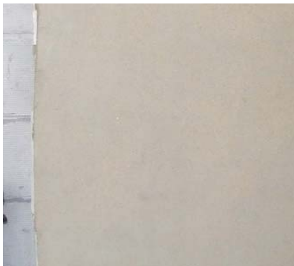
รูปที่ 7.4 การทดสอบการฉาบจริงไม่มีรอยแตกร้าว
