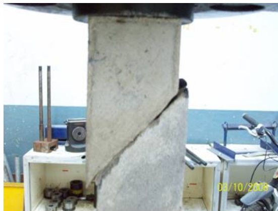
รูปที่ 4.12 การทดสอบการยึดเกาะระหว่างปูนฉาบสำเร็จรูปและคอนกรีตมวลเบา
