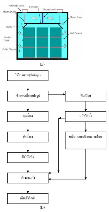
รูปที่ อ(1) กระบวนการอบแห้งไม้แบบดั้งเดิม ( เตาอบแบบ Conventional Kiln) [4]
