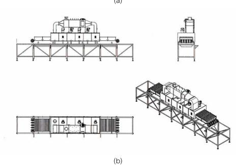
รูปที่ 2 แนวคิดการออกแบบระบบอบแห้งไม้ยางพาราเชิงพาณิชย์โดยใช้ไมโครเวฟชนิดป้อนคลื่นหลาย ตำแหน่งที่ไม่สมมาตรร่วมกับระบบลมร้อนและสายพานลำเลียงอย่างต่อเนื่อง
