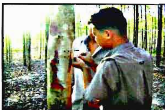
ภาพที่ 5 กล่องบันทึกข้อมูล DL 2e และการเจาะลำต้นเพื่อติดตั้งเข็มนำสัญญาณ
