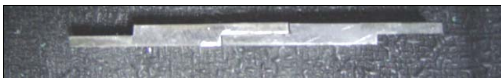
รูปที่ 3.2 ลักษณะรูปร่างของชิ้นงานทดสอบการรับแรงเฉือน
