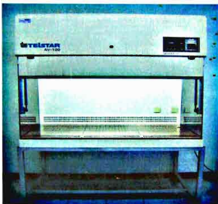
ภาพที่ ข.3 ตู้ปลอดเชื้อ (laminar flow biohazard cabinet)
