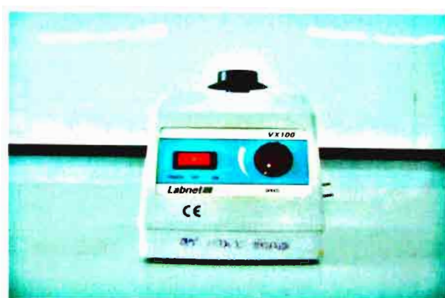
ภาพที่ ข.9 เครื่องเขย่าสาร (vortex mixer)
