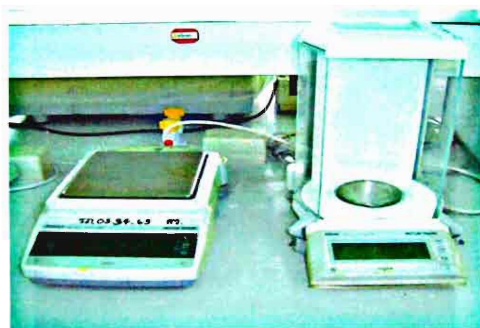
ภาพที่ ข.8 เครื่องชั่งตาร (balance)
