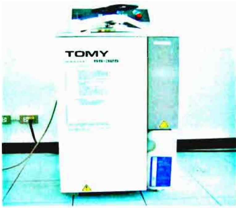
ภาพที่ ข.1 เครื่องนึ่งฆ่าเชื้อด้วยไอน้ำ (autoclave)
