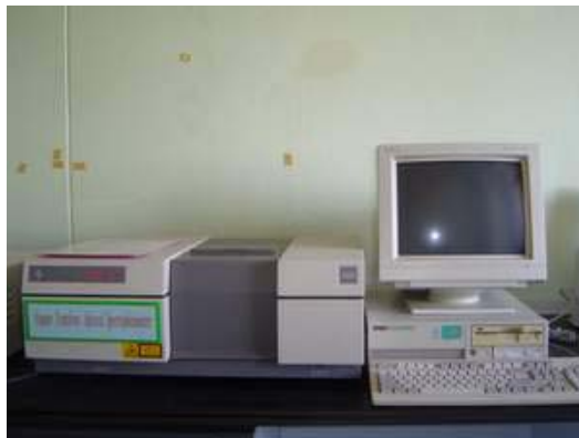
รูปที่ 3.13 เครื่อง Fourier Infrared spectroscopy (FTIR) ของบริษัท Nicolet
