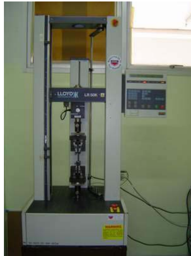
รูปที่ 3.9 เครื่อง Universal Testing Machine ของบริษัท LLOYD Instruments
