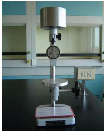
รูปที่ 3.11 เครื่องทดสอบความแข็ง Durometer สเกล shore D ของบริษัท PTC ® Instrument
