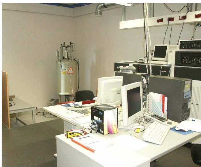
รูปที่ 3.17 เครื่อง NMR ระบบ CP/MAS ของบริษัท Bruker รุ่น AVANCE 300
