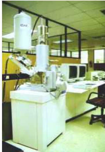
รูปที่ 3.12 เครื่อง SEM ของ CamScan Analytical รุ่น Maxin 2005
