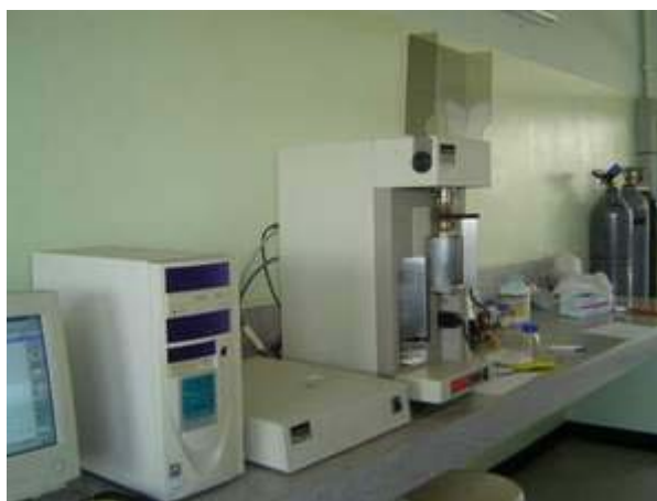
รูปที่ 3.7 เครื่อง Thermogravimetric analyzer (TGA) ของบริษัท Perkin Elmer
