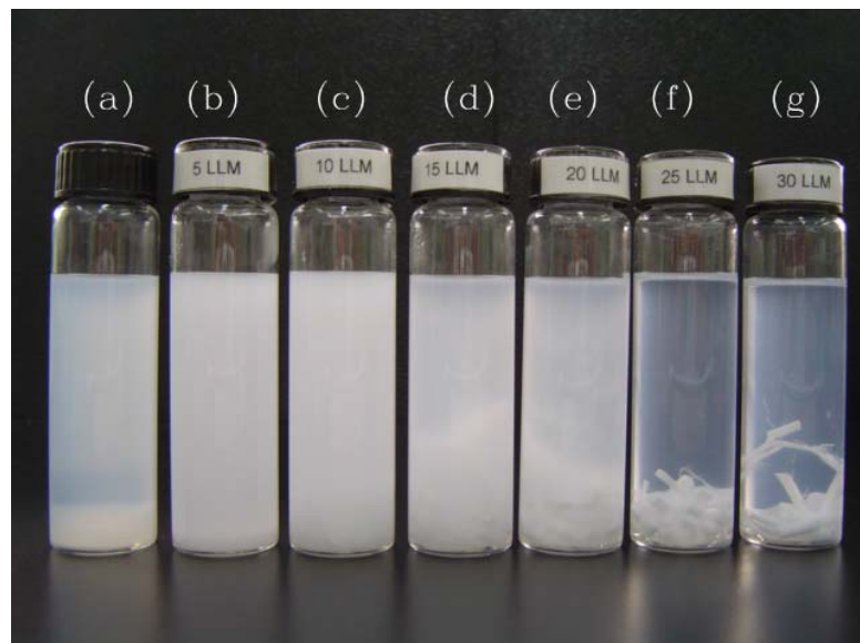
รูปที่ ๓.๔ การละลายของ PVC/LLDPE (MFI = 20g/10min) ในตัวทำละลาย THF ซึ่งผสม LLDPE จำนวน (a) 0 phr, (b) 5 phr, (c) 10 phr, (d) 15 phr, (e) 20 phr, (f) 25 phr และ (g) 30 phr
