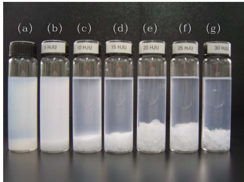
รูปที่ ง.1 การละลายของ PVC/HDPE (MFI = 5g/10min) ในตัวทำละลาย THF ซึ่งผสม HDPE จำนวน (a) 0 phr, (b) 5 phr, (c) 10 phr, (d) 15 phr, (e) 20 phr, (f) 25 phr และ (g) 30 phr
