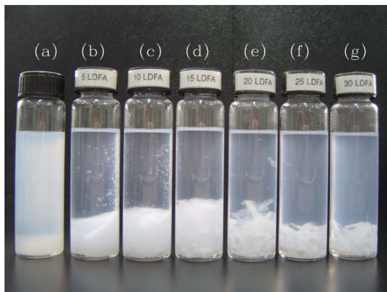
รูปที่ ๕.๕ การละลายของ PVC/LDPE (MFI = 5g/10min) ในตัวทำละลาย THF ซึ่งผสม LDPE จำนวน (a) 0 phr, (b) 5 phr, (c) 10 phr, (d) 15 phr, (e) 20 phr, (f) 25 phr และ (g) 30 phr
