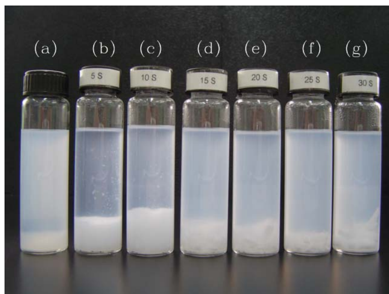
รูปที่ ๕.๖ การละลายของ PVC/LDPE (MFI = 20g/10min) ในตัวทำละลาย THF ซึ่งผสม LDPE จำนวน (a) 0 phr, (b) 5 phr, (c) 10 phr, (d) 15 phr, (e) 20 phr, (f) 25 phr และ (g) 30 phr
