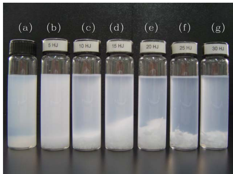
รูปที่ ง.2 การละลายของ PVC/HDPE (MFI = 20g/10min) ในตัวทำละลาย THF ซึ่งผสม HDPE จำนวน (a) 0 phr, (b) 5 phr, (c) 10 phr, (d) 15 phr, (e) 20 phr, (f) 25 phr และ (g) 30 phr
