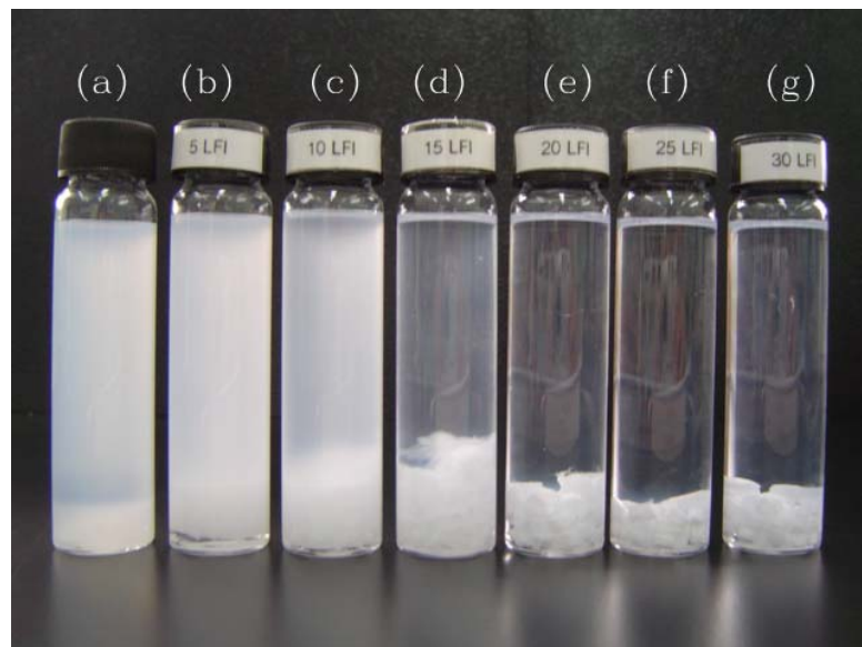
รูปที่ ๓.๓ การละลายของ PVC/LLDPE (MFI = 5g/10min) ในตัวทำละลาย THF ซึ่งผสม LLDPE จำนวน (a) 0 phr, (b) 5 phr, (c) 10 phr, (d) 15 phr, (e) 20 phr, (f) 25 phr และ (g) 30 phr
