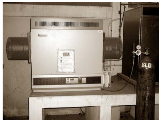
รูปที่ 4 แสดงอุปกรณ์ที่ใช้ในการวิจัย (ก) เครื่องบดผสมชนิดพลังงานสูง (ข) ชุดเตาอบควบคุมบรรยากาศอุณหภูมิสูง
