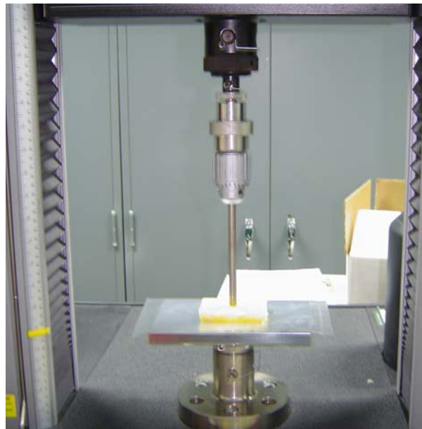
ภาพที่ 3 การวัดค่าความแน่นเนื้อชิ้นสัปปะรดด้วยเครื่อง Instron
