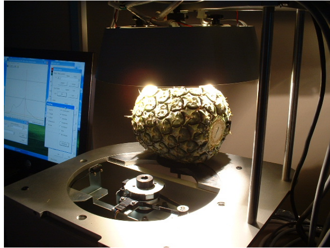
ภาพที่ 2 สแกนผลสัปปะรดด้วยเครื่อง Near Infrared Spectroscopy
