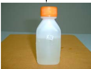
ภาพประกอบที่ 3.9 การสกัดโลหะหนักออกจากดินด้วยวิธีการย่อยด้วยกรด
