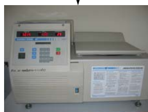
(c) นำไปแยกชั้นของดินกับสารละลาย โลหะหนักด้วยเครื่อง Centrifuge
