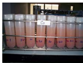
(a) นำดินผสมกับสารละลายโลหะหนัก ที่ความเข้มข้นต่างๆ
