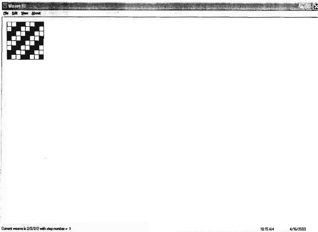
รูปที่ 3.19 ภาพแสดง weave pattern ของลายทแยง
