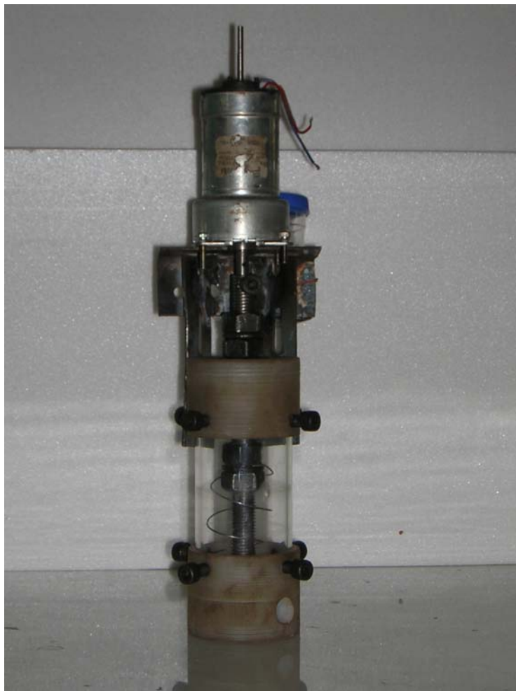
รูปที่ 3.9 ชุดปั๊มฝุ่นที่จัดสร้างขึ้นใหม่
