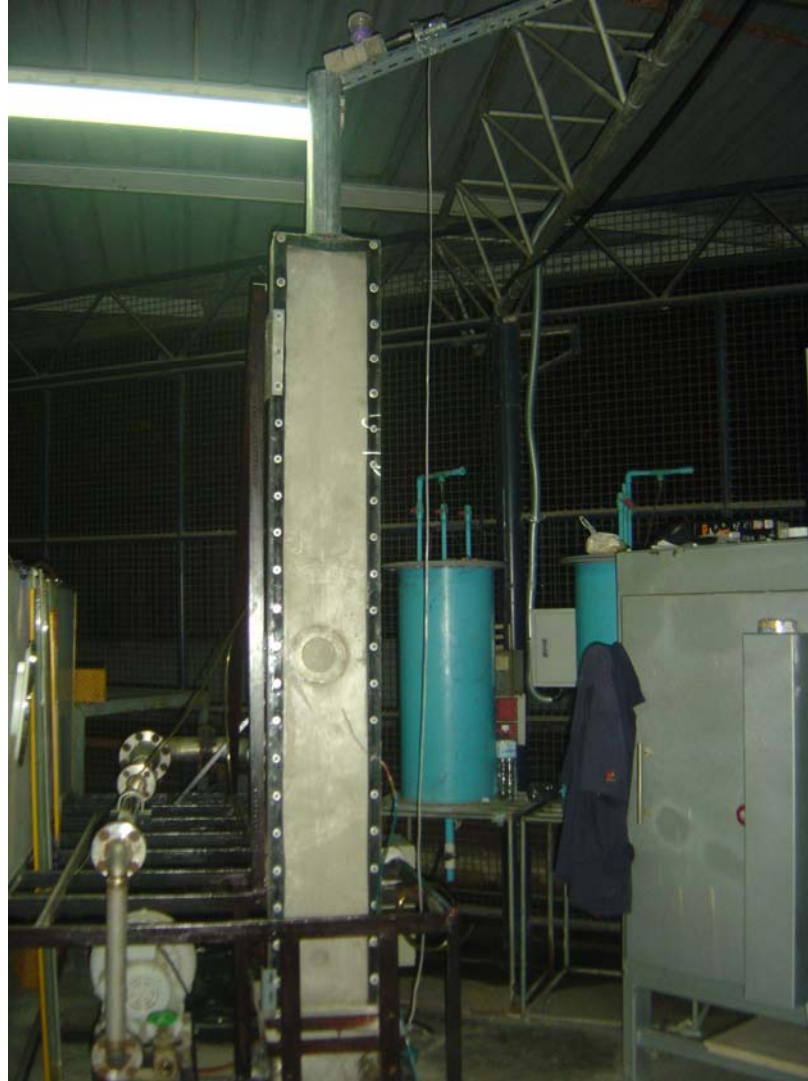
รูปที่ 3.13 การติดตั้งเครื่องมือชุดป้อนฝุ่นเข้ากับชุดทดสอบ
