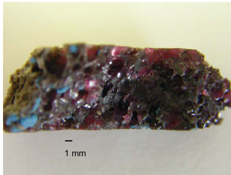
รูปที่ ข.1 แผ่นกรองเซรามิกเผาที่อุณหภูมิ 700°C อัดเรซินเพื่อทดสอบรูพรุนเปิดต่อถึงกัน
