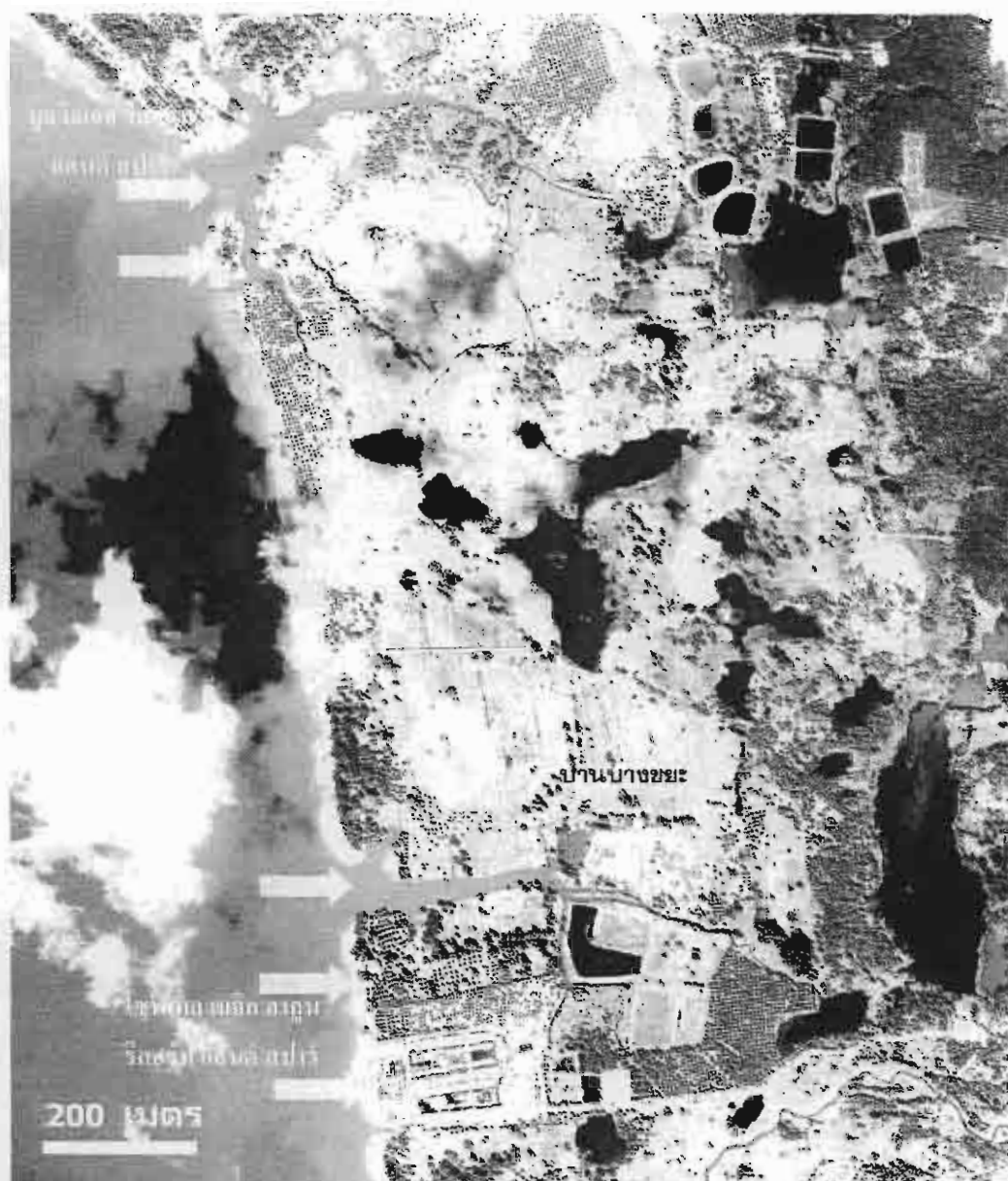
รูปที่ 4.5 ภาพถ่ายดาวเทียม IKONOS ที่บันทึกได้เมื่อวันที่ 29 ธันวาคม 2547 ในบริเวณตอนล่างของแหลมปะการัง จนถึงบ้านคึกคัก จังหวัดพังงา ลูกศรแสดงตำแหน่งที่พบการกัดเซาะตะกอนหน้าหาดจากการสำรวจภาคสนาม (ข้อมูลภาพถ่ายดาวเทียมจากโฮมเพจ GISTDA)
