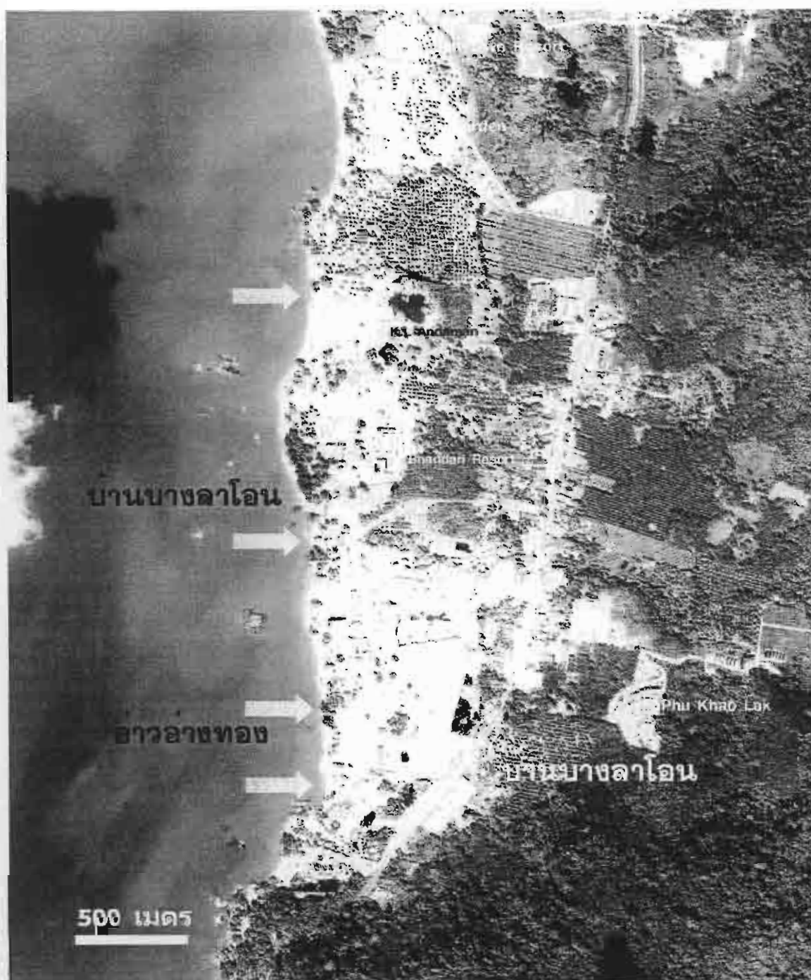
รูปที่ 4.9 ภาพดาวเทียม IKONOS แสดงการกัดเซาะชายฝั่งตั้งแต่หาดนางทอง ลงมาทางตอนใต้ถึงอ่าวอ่างทอง บ้านบางลาโณ จังหวัดพังงา (ตำแหน่งในลูกศรชี้) (ข้อมูลภาพดาวเทียมจาก GISTDA)
