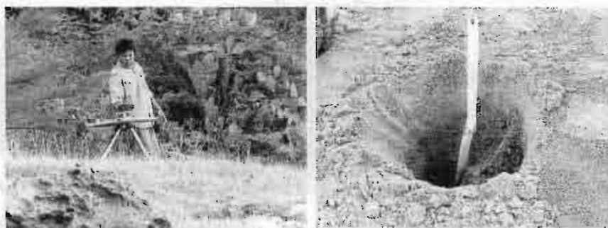
รูปที่ 1.2 การวัดระดับพื้นที่ที่น้ำหาดในภาคสนามโดยใช้กล้องวัดระดับบนแผ่นระนาบ (รูปซ้าย) และการปักหมุดหลักเพื่อวัดระดับตะกอนในรอบปี (รูปขวา)
