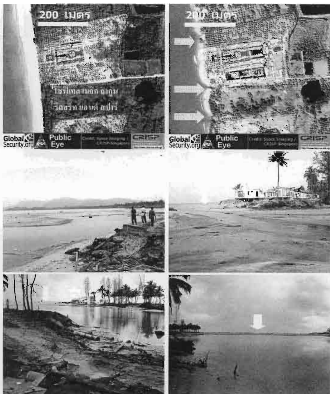
รูปที่ 4.7 ภาพดาวเทียม IKONOS ก่อนและหลังสึนามิในบริเวณโซฟิเทล เมจิก ลากูน บ้านคึกคัก จังหวัดพังงา (ข้อมูลภาพจากโฮมเพจของ CRISP) จะเห็นการกัดเซาะบริเวณหน้าหาดชัดเจน (ตำแหน่งที่ลูกศรชี้) และสองรูปภาพกลาง แสดงพื้นที่ที่ถูกกัดเซาะจากการสำรวจภาคสนาม เมื่อวันที่ 8 มกราคม 2548 ส่วนสองรูปล่างแสดงการฟื้นตัวของตะกอนที่มาปิดกั้นปากคลองในบริเวณใกล้เคียง บันทึกภาพเมื่อวันที่ 14 พฤษภาคม 2548
