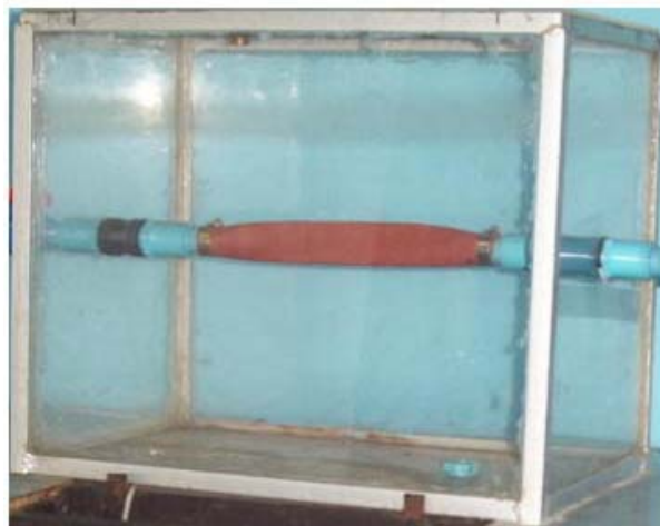
รูปที่ 4.3 ส่วนของห้องทดสอบที่มีการบรรจุน้ำเพื่อรักษาความดันภายนอกท่อที่ทำการทดสอบ
