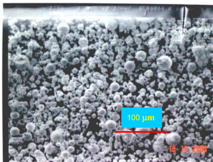
รูปที่ 3.2 แสดงลักษณะอนุภาค Fly ash ด้วยเครื่อง SEM
