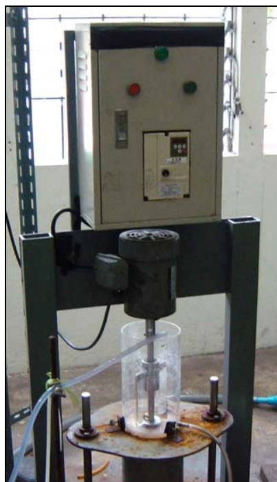
รูปที่ 2.4 แสดงชุดอุปกรณ์ผลิตฟองแก๊สแอฟรอนแบบ Spinning disc
