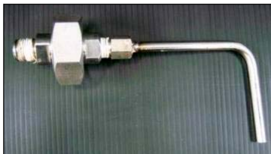
รูปที่ 2.6 แสดงหัวเก็บตัวอย่างฝุ่น (Nozzle) และอุปกรณ์สะสมอนุภาค (Filter holder)
