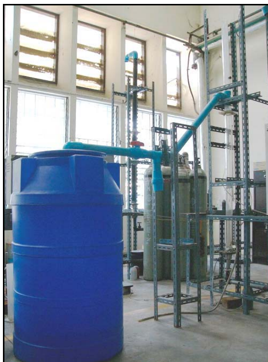
รูปที่ 2.5 แสดงหอดักจับฝุ่นและถังแยกแอฟรอน
