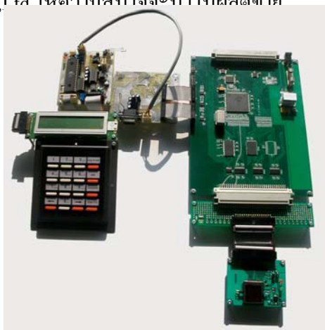
รูปที่ 1 ฮาร์ดแวร์ตรวจสอบลายนิ้วมืออัตโนมัติที่ออกแบบและพัฒนาโดยคนไทยทั้งหมด เป็นต้นแบบทดสอบภาคสนาม สามารถประมวลผลได้ในตัว (Standalone)
