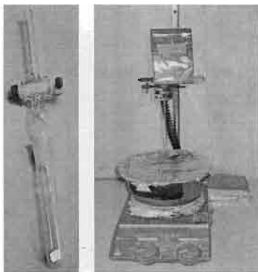
รูปที่ 3.1 ชุดอุปกรณ์สำหรับทำปฏิกิริยา ROP
