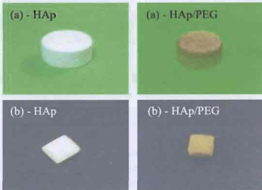
รูปที่ 3.2 ลักษณะทางกายภาพของก้อน HAp บริสุทธิ์ และ วัสดุเชิงประกอบ HAp/PEG ที่เตรียมได้จากสภาวะในการทำปฏิกิริยา ROP ที่อุณหภูมิ 200^{\circ}\text{C} เวลา 24 ชั่วโมง โดยขึ้นรูป HAp ด้วย (a) เครื่องอัดไฮดรอลิก และ (b) แบบกรองลดความดัน
