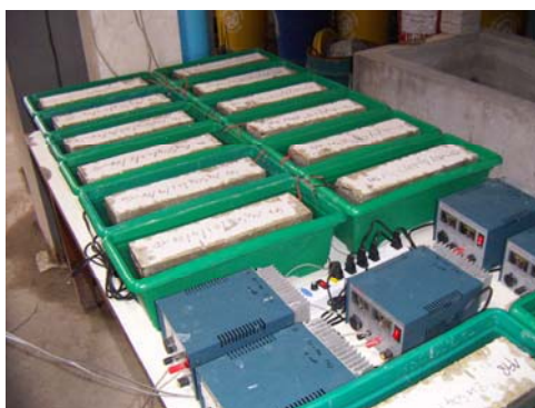
(ก) การซ่อมแซมรอยแตกร้าวด้วย Electrodeposition
