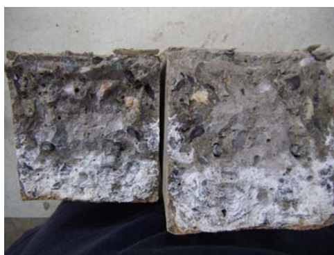
(ค) การตกผลึกเข้าไปในรอยแตกร้าวของคอนกรีต
