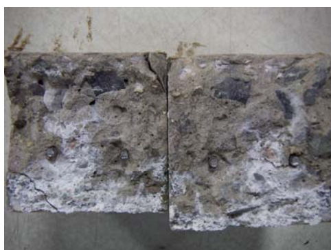
(ค) การตกผลึกเข้าไปในรอยแตกร้าวของคอนกรีต
