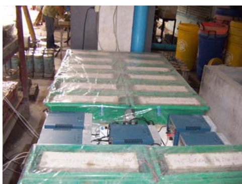
(ข) คลุมตัวอย่างที่ทดสอบด้วยพลาสติก เพื่อป้องกันการระเหยของสารละลาย
