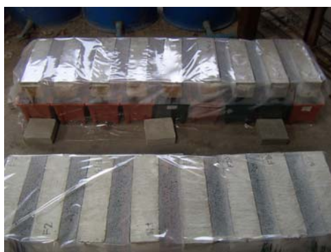
(ค) ตัวอย่างคอนกรีตเสริมเหล็กที่อยู่ภายในไอระเหยของสารละลายโซเดียมคลอไรด์
