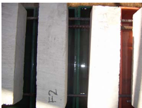
(ก) การทดสอบการซึมผ่านของคลอไรด์
