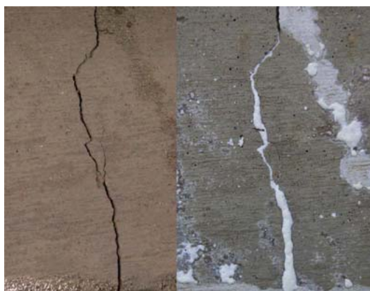
ภาพที่ 14 เปรียบเทียบรอยแตกร้าวของตัวอย่างก่อนและหลังการทดสอบด้วยสารละลาย \text{MgCl}_2 ความเข้มข้น 0.2 โมลต่อลิตรที่ใช้ศักย์ไฟฟ้าภายนอก 6 โวลต์
