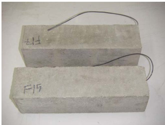
ภาพที่ 9 ตัวอย่างคอนกรีตเสริมเหล็กขนาด 10 x 10 x 37 เซนติเมตร
