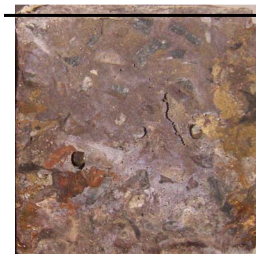
(ข) ความลึกการซึมผ่านของคลอไรด์หลังฉีดพ่นด้วยสารละลายซิลเวอร์ไนเตรด
