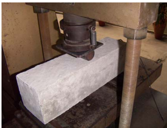
ภาพที่ 10 การกดตัวอย่างทดสอบคอนกรีตเสริมเหล็กเพื่อทำให้เกิดรอยแตกร้าว
