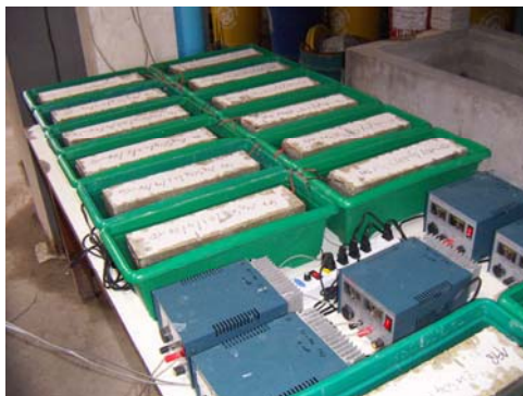
(ก) การซ่อมแซมรอยแตกร้าวด้วย Electrodeposition
