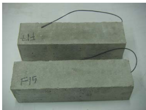
(ข) คอนกรีตเสริมเหล็ก 10 x 10 x 37 ซม.
