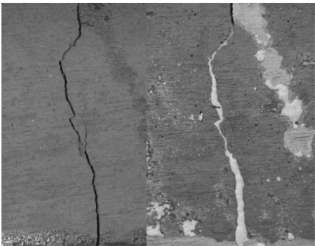
ภาพที่ 3 เปรียบเทียบรอยแตกร้าวของตัวอย่างก่อนและหลังการทดสอบด้วยสารละลาย MgCl_2 ความเข้มข้น 0.2 โมลต่อลิตร
