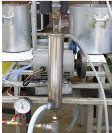
รูปที่ 3.10: ภาพถ่ายแสดงการติดตั้งเครื่องควบแน่น
