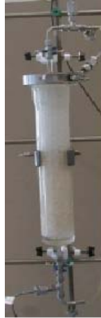
รูปที่ 2.4: การบรรจุสารทำงานในเครื่องดูดซับ (Bach, 2001)
