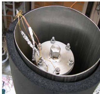
รูปที่ 3.21: การติดตั้งปฏิกรณ์เข้ากับระบบ
