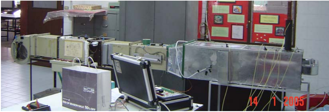
รูปที่ 3.31: ภาพถ่ายการติดตั้งอุปกรณ์วัดและบันทึกข้อมูลการทดสอบ เครื่องแลกเปลี่ยนความร้อน
