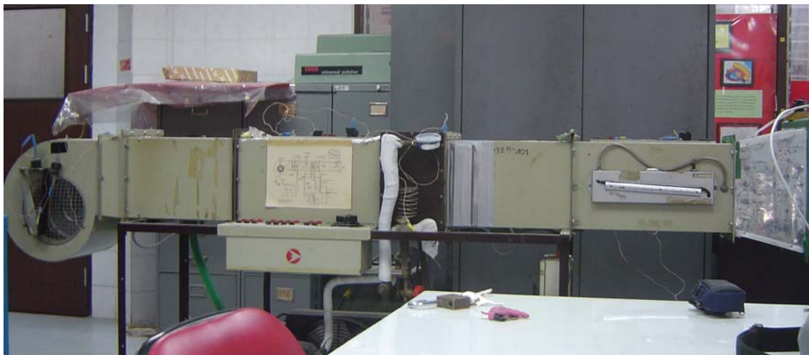
รูปที่ 3.30: ภาพถ่ายด้านหน้าของชุดทดสอบเครื่องแลกเปลี่ยนความร้อนสำหรับส่วนทำระเหย
