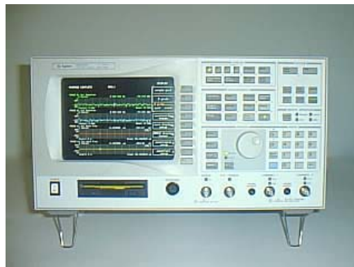
รูปที่ 7.4 อุปกรณ์รับสัญญาณทั้งโดเมนเวลาและโดเมนความถี่ Spectrum Analyzer
