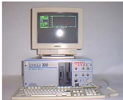
รูปที่ 7.3 อุปกรณ์รับและประมวลสัญญาณ ทางโดเมนเวลารุ่น LOCAN 320
