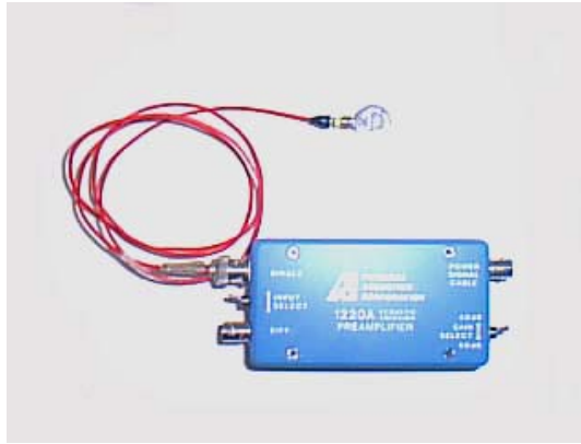
รูปที่ 7.2 แสดงหัวตรวจสอบและอุปกรณ์ขยายสัญญาณเบื้องต้น ซึ่งติดตั้งอุปกรณ์กรองสัญญาณอยู่ภายใน
