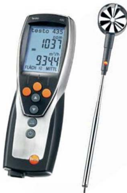
รูปที่ 3.13 อุปกรณ์วัดความเร็วลมเฉลี่ย (Testo model 435)
