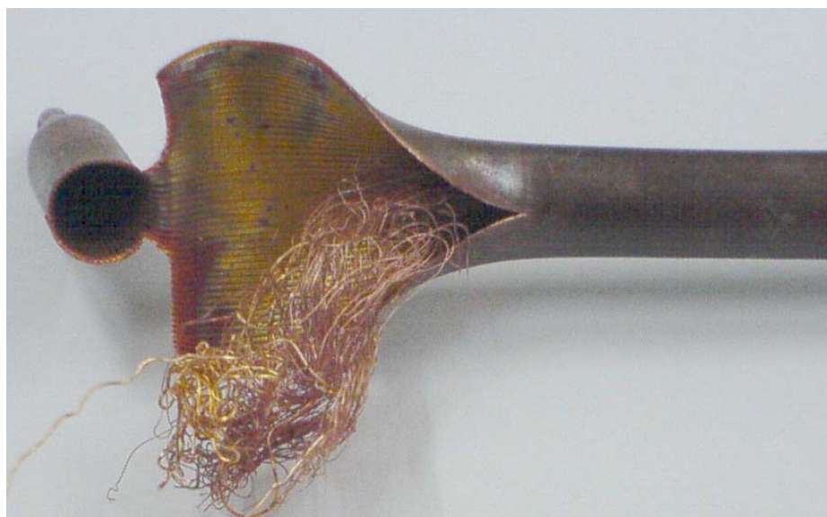
รูปที่ 3.9 ภาพของ Wick ภายใน Heat Pipe
