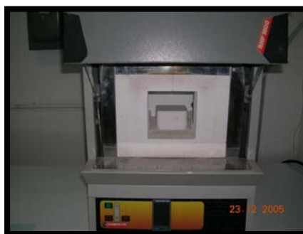
รูป 2.7 การวางถ้วยอะลูมินาในเตาเผาไฟฟ้าเพื่อเผาชิ้นที่อุณหภูมิต่างๆ
